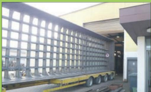
Sonder-Schweißkonstruktion der Firma Sonnentag: ein 30 Tonnen schwerer Formkasten.
