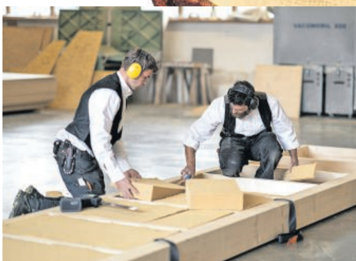
In der Werkstatt von Holzbau Schleicher entstehen zum Teil ganze Holzhäuser. Anhand des Plans werden die Bauelemente in der Werkstatt erstellt und dann auf der Baustelle aufgerichtet.
